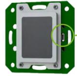
Conector micro-USB en la cara del lector DINMTPX-MF-SA para una fácil programación
