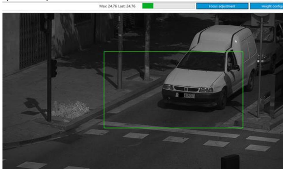
Los valores solo cambian cuando las imágenes contienen matriculas detectadas, el valor **Max** es el máximo valor de foco obtenido, el valor **Last** es el último valor de foco obtenido. Para obtener el máximo valor debe moverse el foco y esperar detección en cada una de las posiciones del foco. Una vez obtenido el máximo posible se debe intentar aproximar el valor de **Last** lo máximo posible a este valor moviendo el foco. Este valor máximo varía dependiendo de la instalación.
