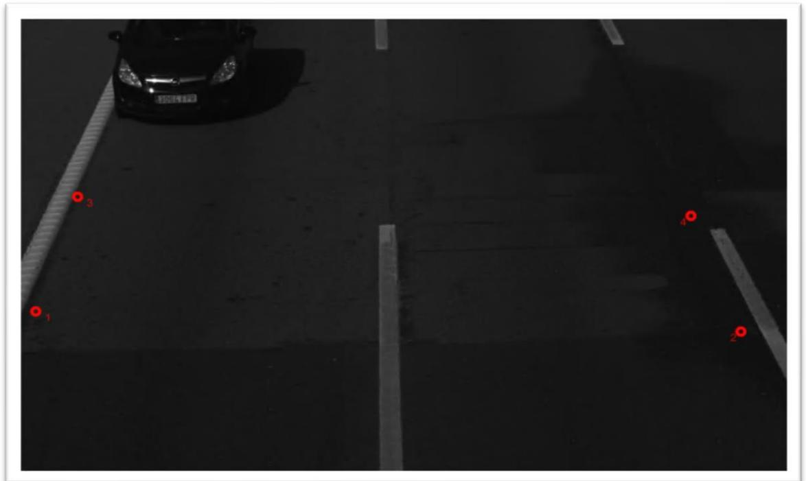
3. Una vez completado la asignación de los 4 puntos pulsar el botón "Calibrate". Con esto la cámara estará calibrada.
