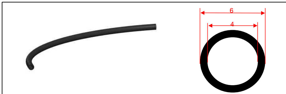
Fig. 13 – Características del tubo Easydetect
