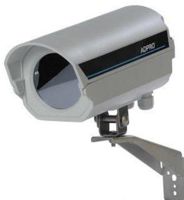
El aparato detecta el movimiento gracias a la tecnología de infrarrojos y a la óptica de espejos de alta precisión. La unidad registra la diferencias de temperatura entre los objetos móviles y el fondo inmóvil. El umbral de alarma del detector se puede ajustar a los factores externos, como las condiciones ambientales. Las interferencias se pueden filtrar gracias a un sofisticado análisis de señales.
