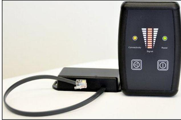
El CT PRO2 consta de un transmisor conectado al terminal RS-485 en el detector y un receptor que funciona con batería.
