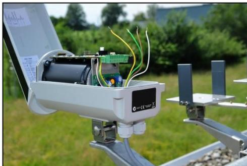
6. Conecte la toma de corriente según el plan de cableado que aparece en la pegatina de dentro de la tapa (consulte también el plan de cableado del capítulo 14).
