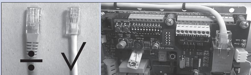
Dirija el cable de red como se muestra en la imagen para asegurarse de que el cable no entorpece con ninguna parte interna del cañón de niebla. Deje que el cable de red salga por el orificio del chasis utilizado para cualquier otro cable de señal, hacia y desde el sistema de alarma.
