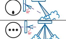
ER390 (3x90°): permette l'erogazione a corto raggio in 3 direzioni diverse; suddivide il getto in due inclinati di 30° ed uno a 90°. Questo tipo di erogatore permette di installare Foggy creando una protezione ad effetto tenda, ad esempio per la protezione di vetrate.
