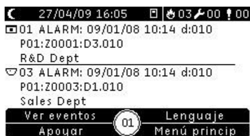
Figura 4: Indicadores de alarma de incendios en la pantalla LCD de la central
