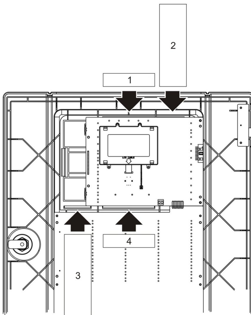
Cada parte insertable está numerada como 1, 2, 3 y 4, y se inserta en la ubicación indicada (con la zona impresa mirando hacia la parte delantera de la central).
