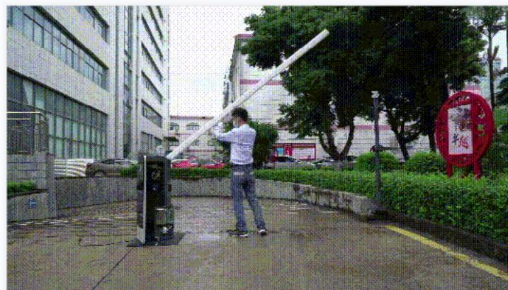
Si el brazo de la pluma es capaz de moverse suavemente hacia arriba a esa posición, entonces significa que la parte mecánica en movimiento y el motor en movimiento está bien.
