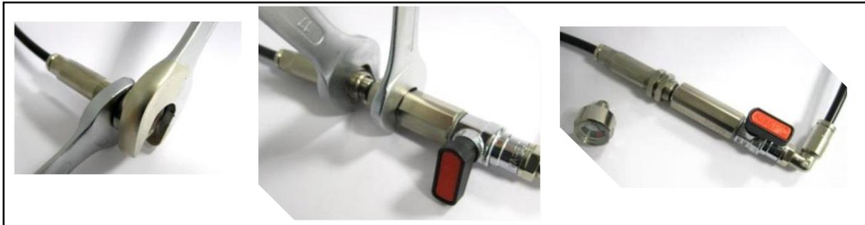
Fig. 47 - Presurización del tubo Easydetect
