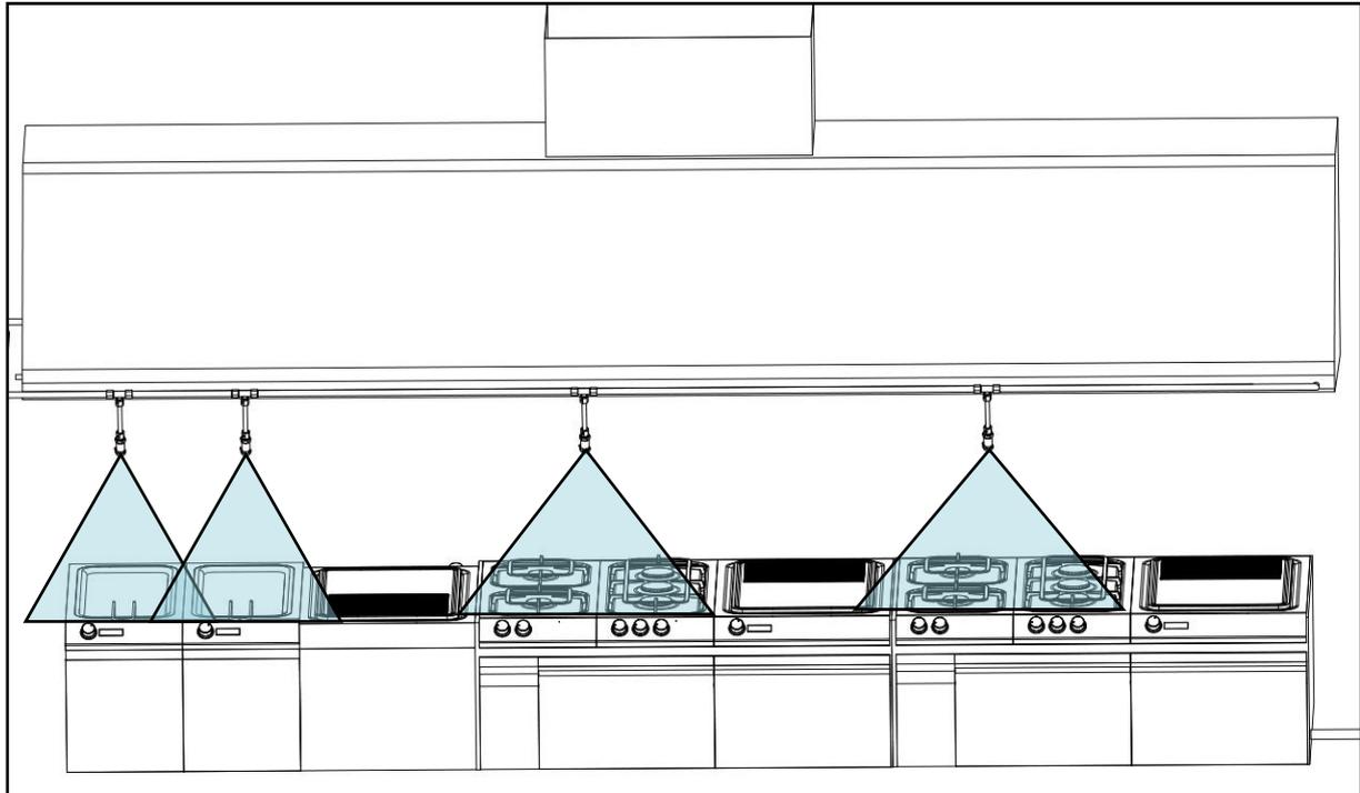
Fig. 4 - Configuración de difusores para PROTECCIÓN POR ZONA
