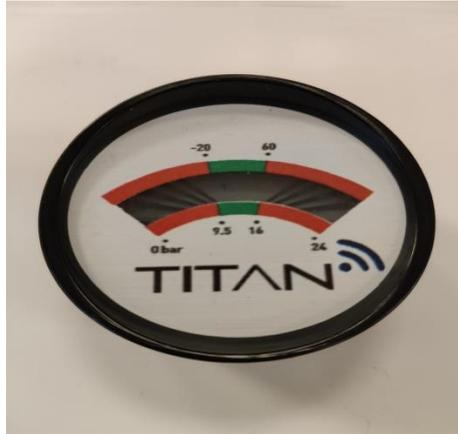
Este error indica que se ha producido un error relativo al sensor de presión. Al término de la señalización del error el manómetro se reiniciará automáticamente.
