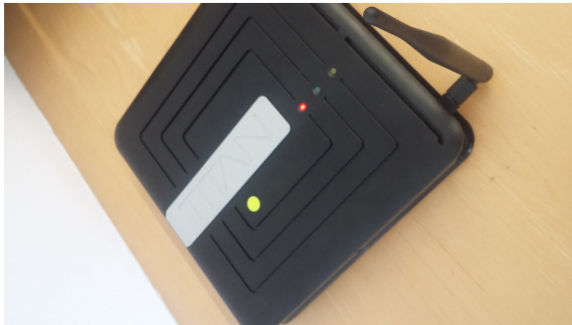
Imagen 22. Módulo con el testigo rojo encendido, indicando que hay conexión de datos Wifi establecida.
