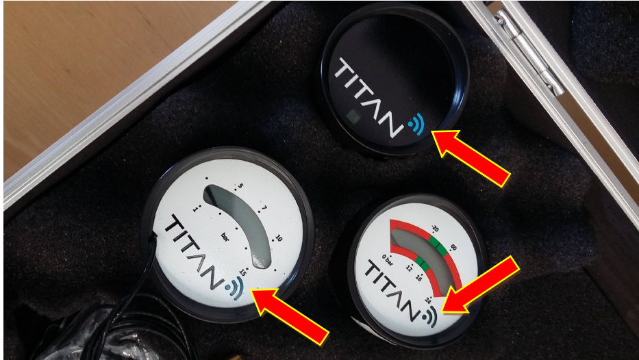
Imagen 3. Punto de conexión NFC de los diferentes manómetros del sistema Titan.
