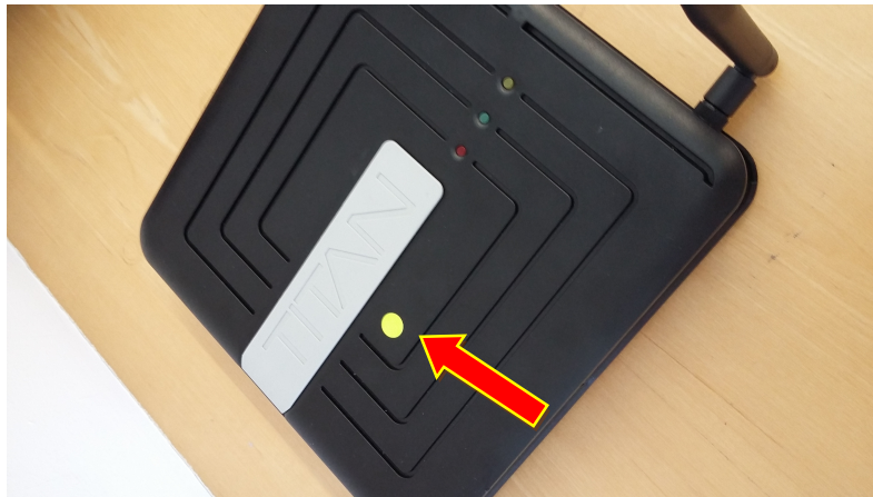
Imagen 2. Punto de conexión NFC del módulo del sistema Titan.
