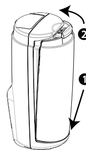
Figura 17: Cierre de la cubierta de la batería
