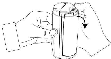
Figura 14: Apertura de la cubierta delantera
