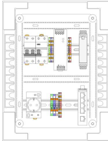
El armario de control para Fuego Industrial contiene todos los elementos necesarios para conectar un sistema oprtrónico SR7®.
