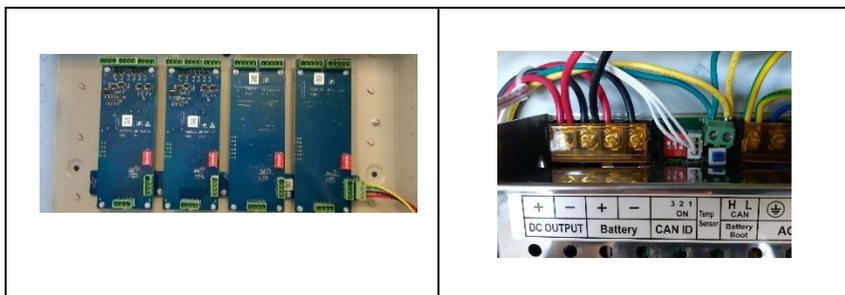
3. Fijar la tarjeta, usando los 4 tornillos proporcionados.
