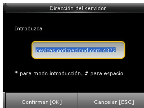
**PASO 6:** Configura la siguiente dirección del servidor: **devices.gotimecloud.com:4372 >** (HTTPS)
