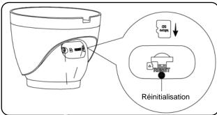
Remarque: pour réinitialiser la caméra (c'est-à-dire rétablir ses paramètres par défaut), appuyez sur le bouton de réinitialisation pendant 10 secondes ; le voyant s'étein
