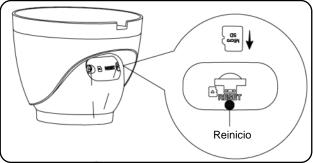
**Nota:** Para Reset (restaurar los ajustes de fábrica de la cámara), mantenga presionado durante 10 segundos y la luz se apagará
