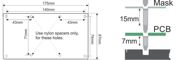
La PCB se puede montar directamente sobre el panel. En este caso, utilice los separadores proporcionados para fijar la placa de protección de la PCB.
