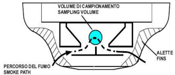
Figura 2: Cámara de medida mostrando el camino del humo
