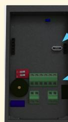
**Micro USB:** Para conectar al ordenador para la configuración y/o actualización del firmware.
