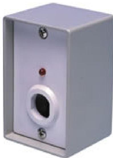
Cajetín de aluminio de superficie para cerraduras de seguridad. Frontal de policarbonato. Con led indicador y resistencia limitadora. Incorpora tamper de protección de tapa y pared. Dimensiones: 60 x 92 x 56 mm.
