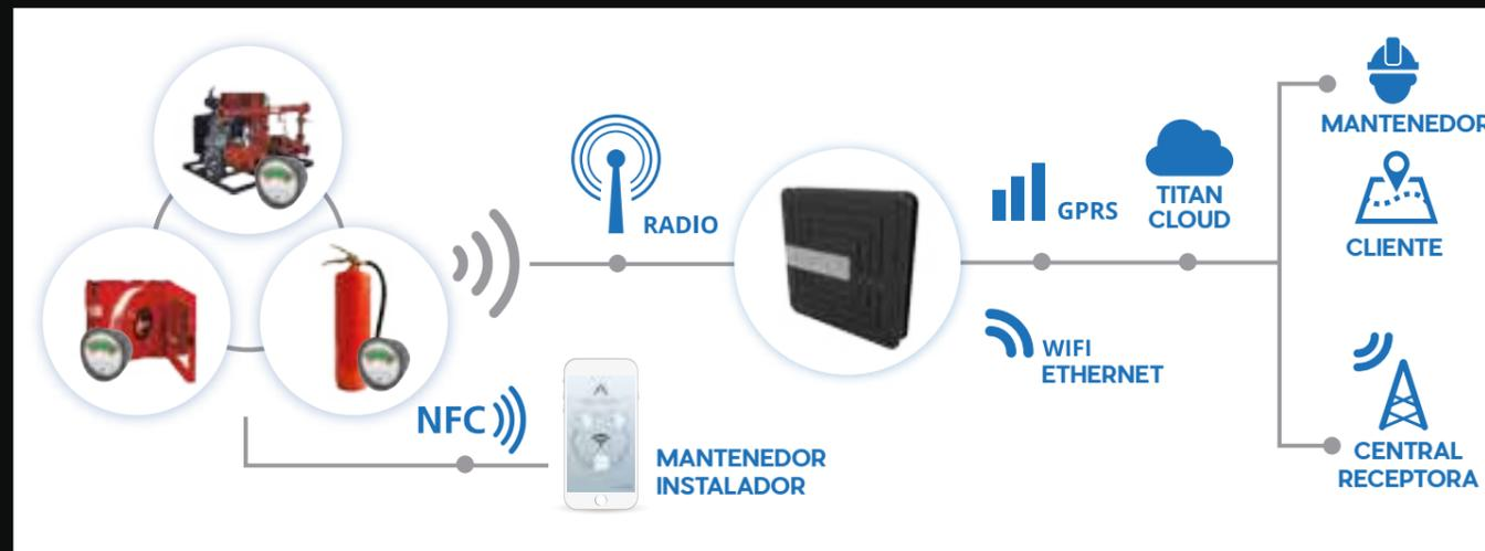
El estado de la instalación es recibido por el cliente final y la empresa mantenedora. Además es posible conectarlo a una central receptora de alarmas.
