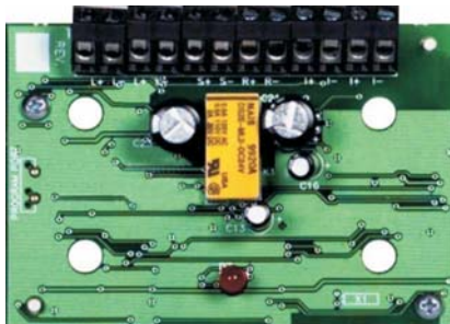
Fig. 1 Módulo de notificación de sirena FC410SMN
