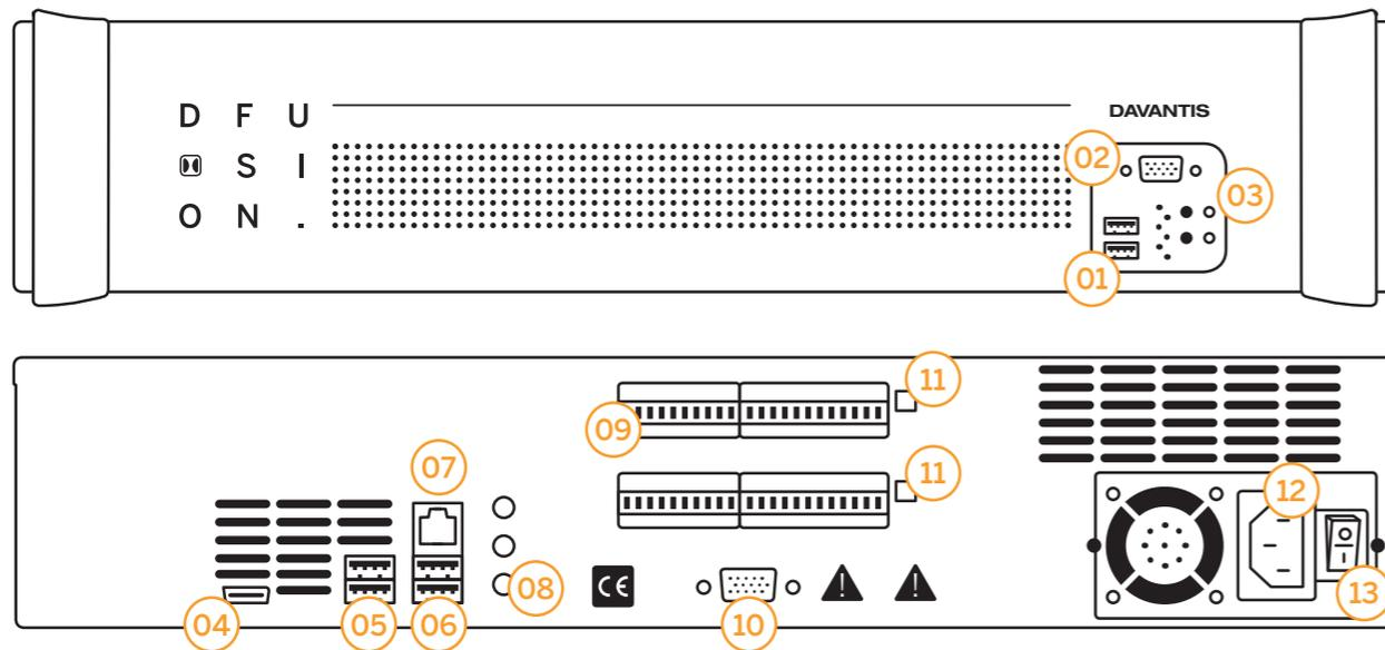
**01** - 2 conexiones USB 2.0 **02** - 1 conexión VGA **03** - 1 interruptor de encendido **04** - 1 conexión HDMI **05** - 2 conexiones USB 3.0 **06** - 2 conexiones USB 2.0 **07** - 1 conector de red RJ45 10/100/1000 **08** - 1 jack estéreo de audio analógico **09** - 8 entradas N/A o N/C **10** - 1 conexión VGA **11** - 4/8/12/16 salidas de relé internas N/C (opcional) **12** - 1 ranura para cable de alimentación **13** - 1 interruptor de alimentación
