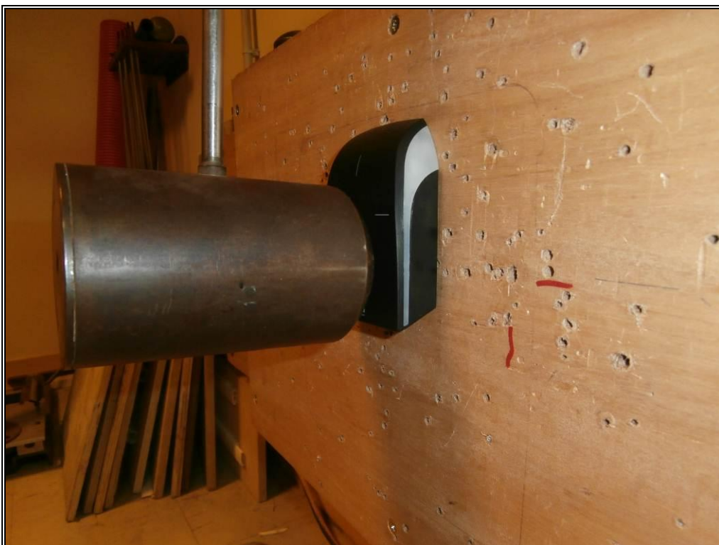
Photographie N°2 : Localisation des impacts (deux impacts réalisés).
