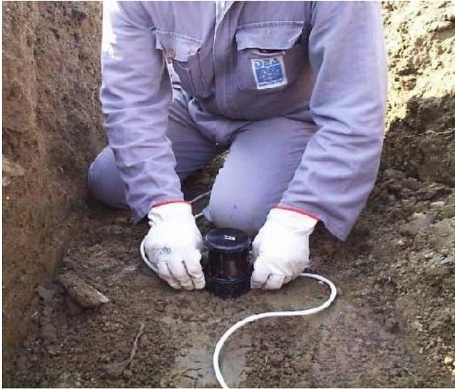
Instalar el sensor empujando la punta en el terreno **sin apretar sobre el techo del mismo**. Mantener el sensor **en eje vertical**.
