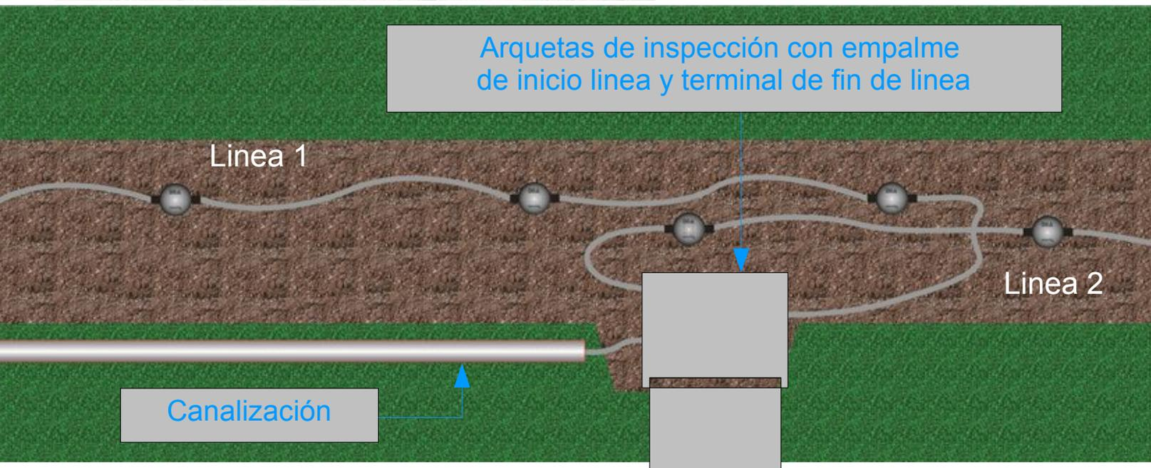
Arquetas de inspección con empalme de inicio línea y terminal de fin de línea
