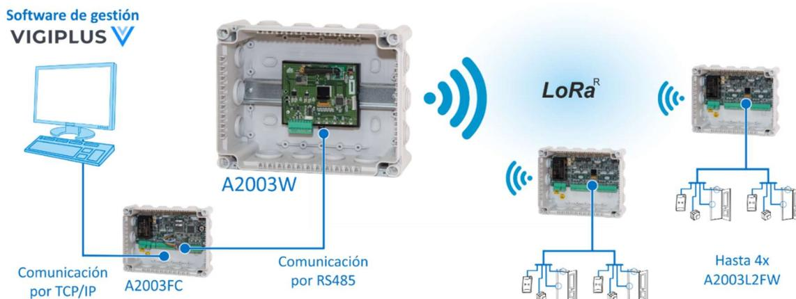
Ilustración 1: Esquema general de conexión de A2003W y A2003L2FW
